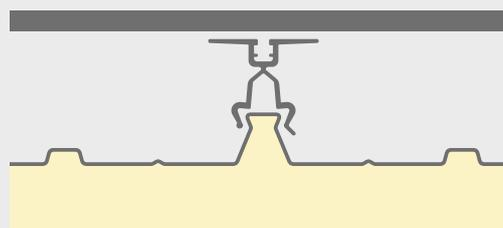
Kein Anbohren der Paneelaußenschale mehr erforderlich durch patentiertes Klemm-System
