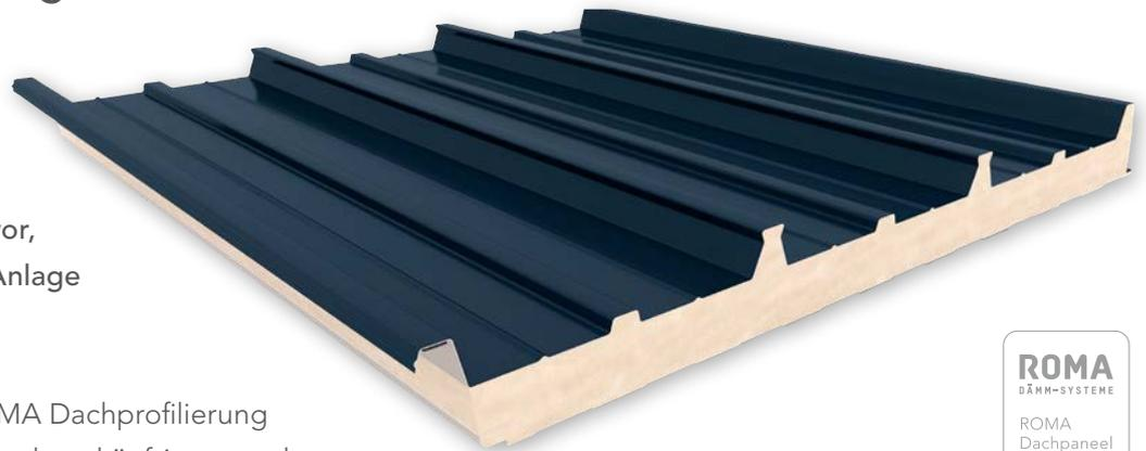
Durch die pilzkopffartige ROMA Dachprofilierung können Sie Ihre Photovoltaikanlage künftig ganz ohne Anbohren der Paneelaußenschale anbringen. Formschlüssige, patentierte Klemmen ermöglichen die einfache und schnelle Montage Ihrer PV-Anlage und machen das Dachpaneel zu einer guten Wahl für alle, die ein qualitativ hochwertiges, energieeffizientes und zukunftssicheres Sandwichdach suchen.
